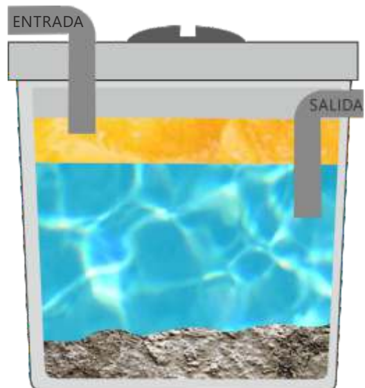
Ilustración 44: Esquema de la trampa de grasas.
