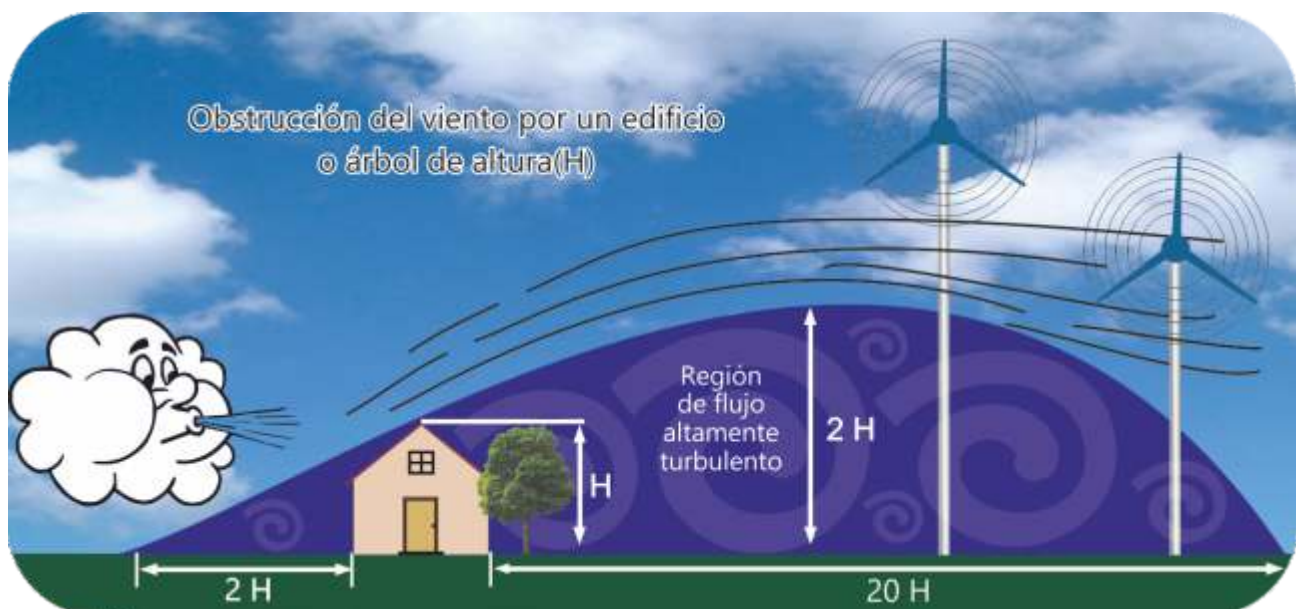
Ilustración 6: Efecto de obstáculos en las cercanías de los aerogeneradores
