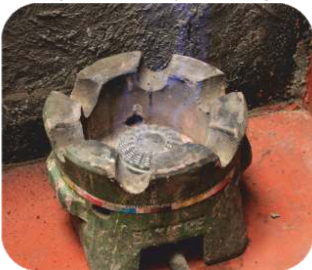
Fotografía 39: Cocina quemando biogas
