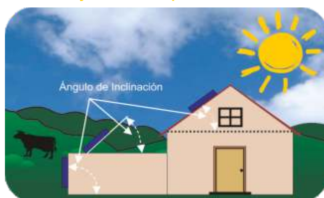
Ilustración 3: Ángulo de inclinación y acimutal de paneles solares
